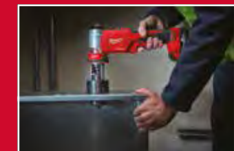
PUNCH - stačí zmáčkнуть spínač, aby se díra lehce vystrhla.
