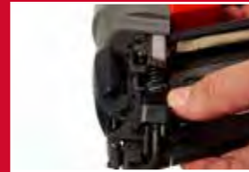
Nastavení hloubky nastřelení bez použití nářadí
