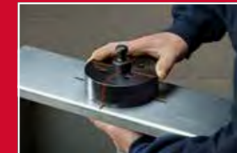
SET UP - výrazné křížky a jasný pohled na pracovní plochu umožňují rychlé a snadné vyrovnání
