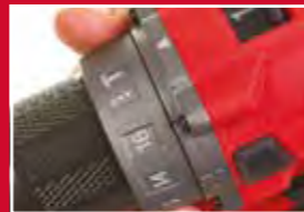
Elektronická spojka s 13 nastaveními točivého momentu
