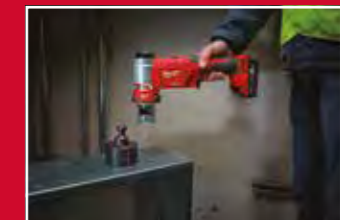
CONNECT - uchopte nástroj a přitiskněte ho k rychlému připojení
